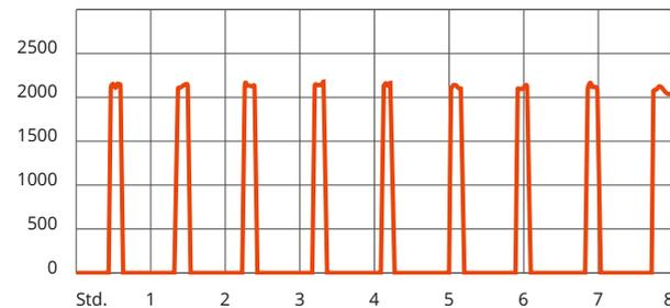
Während des achtstündigen Tests hat die Schnatterer Elektroflächenspeicherheizung S 201 mit 2.000 Watt Leistung insgesamt 3,440 kW Strom verbraucht. Eine Nachtspeicherheizung verbraucht bei vergleichbaren Bedingungen ca. 25 - 30 % mehr Energie.
